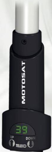
*MotoSat est un système d'antenne satellite semiautomatique muni de moteur électrique à 12 Volts qui facilite considérablement l'opération d'ouverture et repliage de l'antenne et qui accélère le pointage du satellite. Tout le mécanisme électronique a été intégré dans une poignée ergonomique à deux boutons qui permettent d'ouvrir et replier l'antenne à discrétion.*
