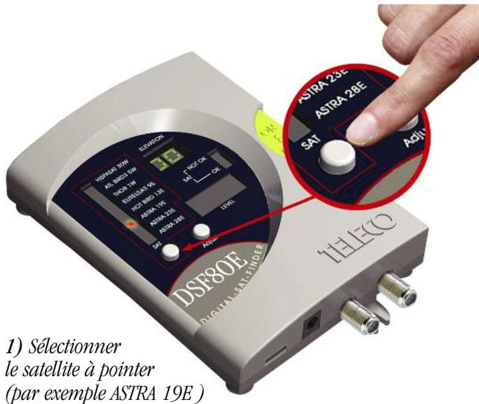
1) Sélectionner le satellite à pointer (par exemple ASTRA 19E)
