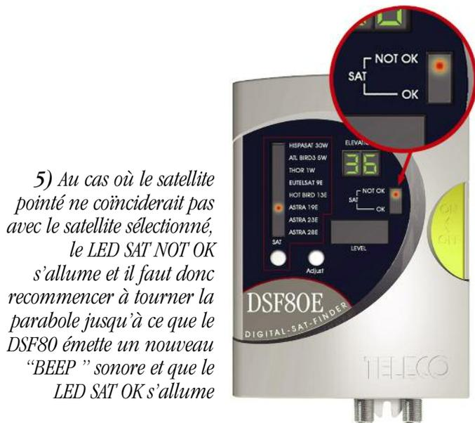
5) Au cas où le satellite pointé ne coïnciderait pas avec le satellite sélectionné, le LED SAT NOT OK s'allume et il faut donc recommencer à tourner la parabole jusqu'à ce que le DSF80 émette un nouveau "BEEP" sonore et que le LED SAT OK s'allume
